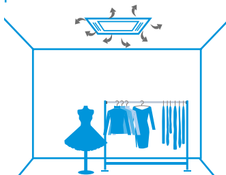
Rozkład powietrza z zabrudzonym filtrem
